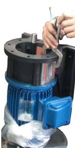
2. 將腳座螺絲孔位對正馬達平面之螺孔孔位。
