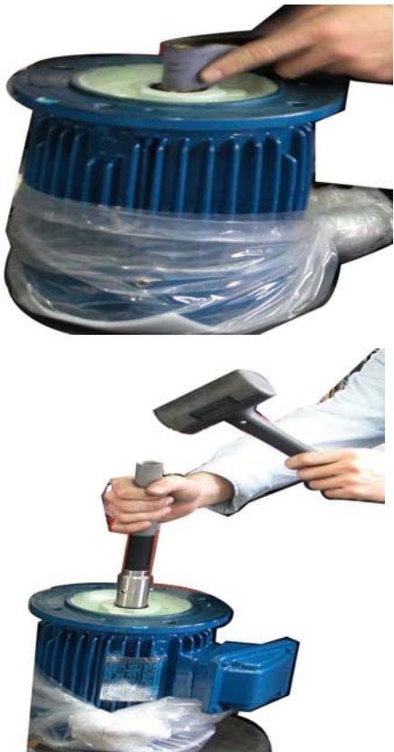
3. 在馬達軸心表面塗上一層保護油脂(牛油)。
